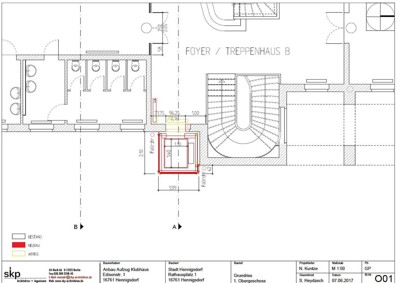
**Grundriss Obergeschoss mit Fahrstuhlanbau**
