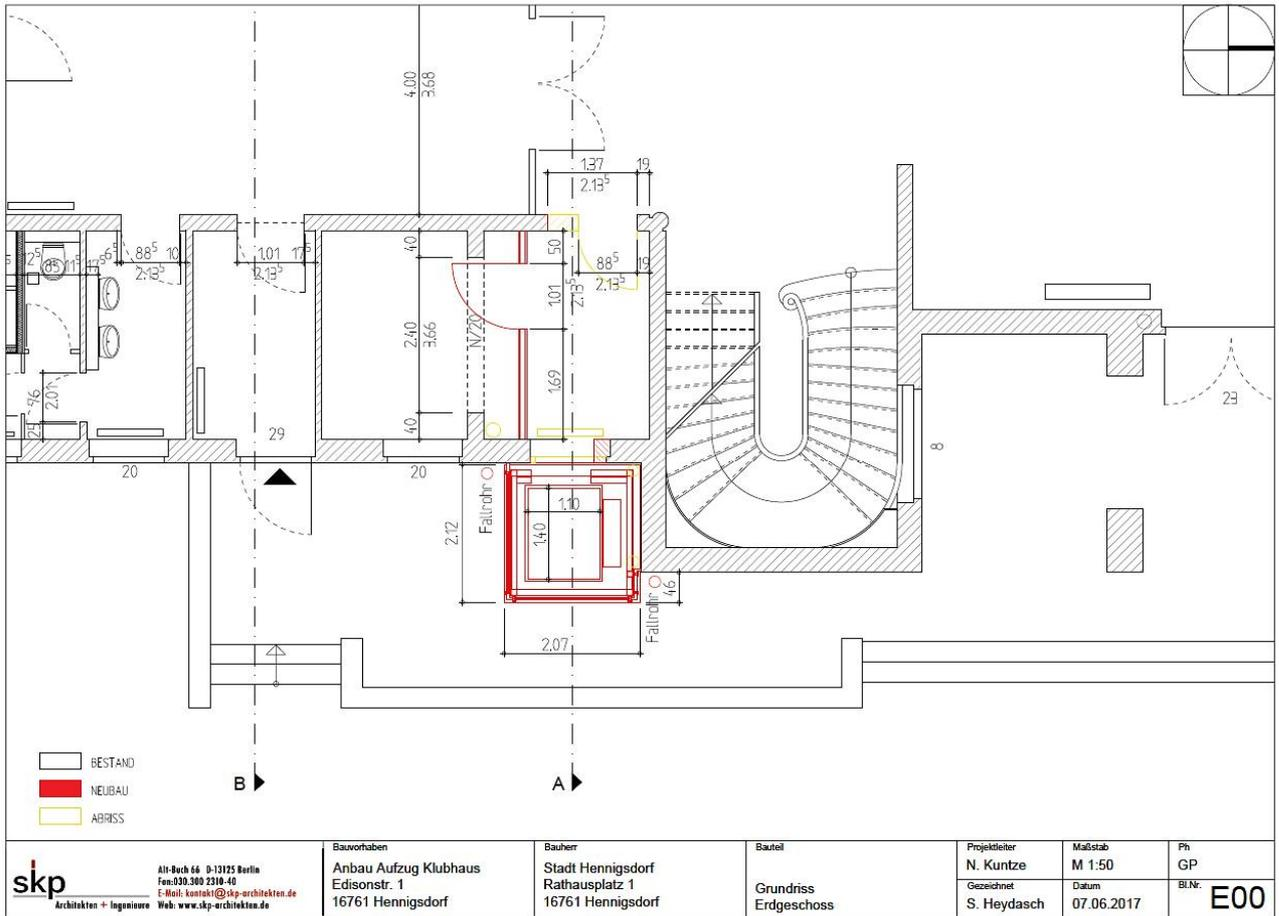
**Grundriss Erdgeschoss mit Fahrstuhlanbau**
